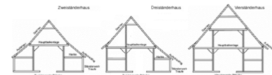
Aufbau Traggerüst Hallenhaus (2)
